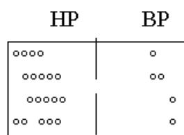
Fig.4.1: Détente irréversible d'un gaz
